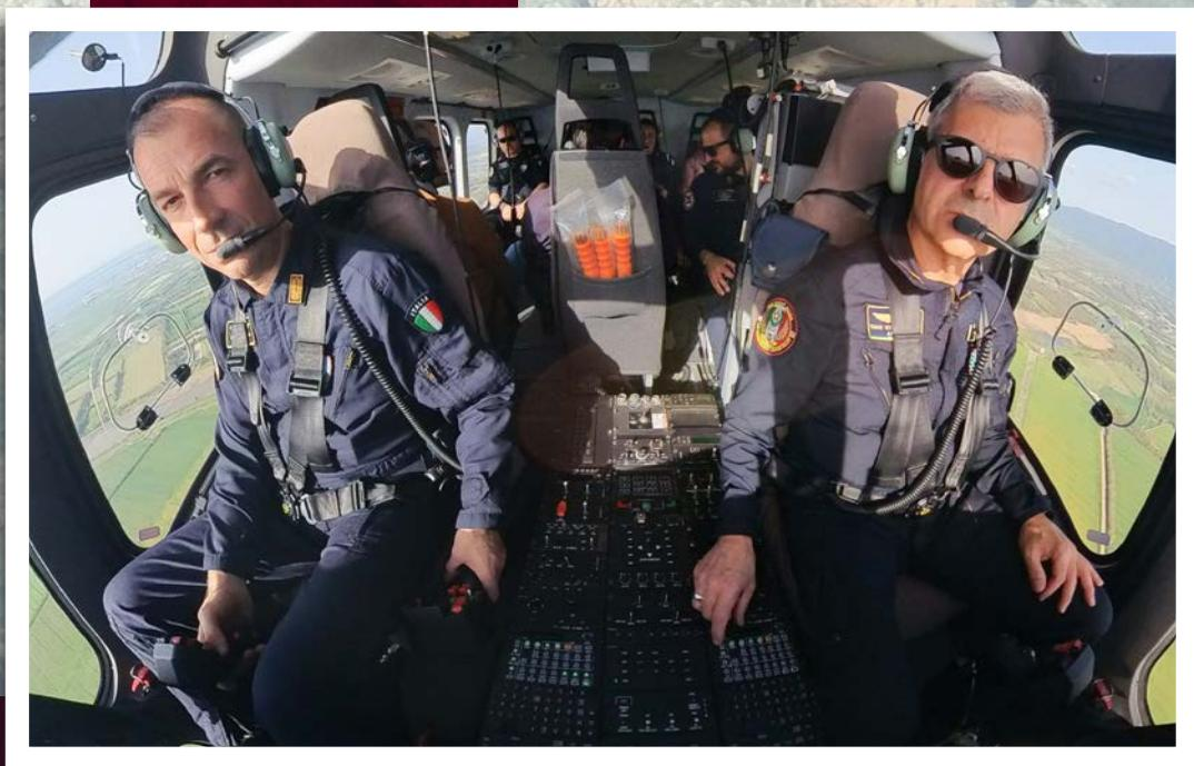
piloti – sono tre: il ciclico, una *cloche* che permette il movimento dell'elicottero in tutte le direzioni; il collettivo, posizionato a sinistra che si usa per aumentare o diminuire la potenza del motore e infine la pedaliera, che consente di cambiare la direzione del rotore di coda, permettendo il controllo sull'asse verticale a sinistra o a destra. Infine c'è anche il *Fms* (Flight management system), un computer di bordo che permette ai piloti la gestione del volo dell'aeromobile.
